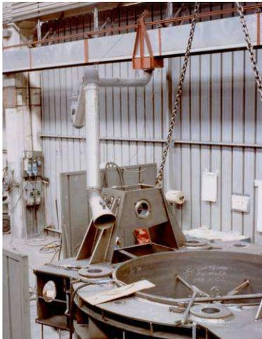
I bracci aspiranti a pantografo vengono utilizzati per aspirare alla sorgente fumi, odori, vapori, gas, polveri ed ogni altro inquinante prodotto nell' ambiente di lavoro.
