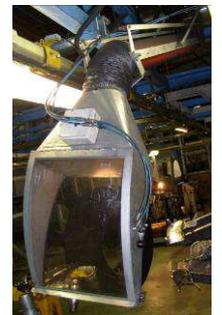
Il basamento, detto *ralla*, poggia su guarnizioni autolubrificanti ed è girevole a 360° per permettere il corretto posizionamento del braccio rispetto alla sorgente di emissione dell'inquinante.
