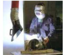
Il braccio aspirante è caratterizzato da una struttura portante esterna al tubo aspirante a quattro pantografi, completamente bilanciato da molle e senza nessun componente immerso nel flusso di aspirazione.
